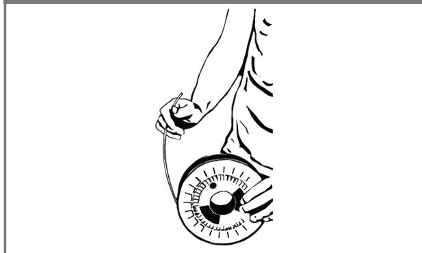
Coloca la bobina en el soporte en un lateral y apróximelo al extrusor todo lo que pueda.
